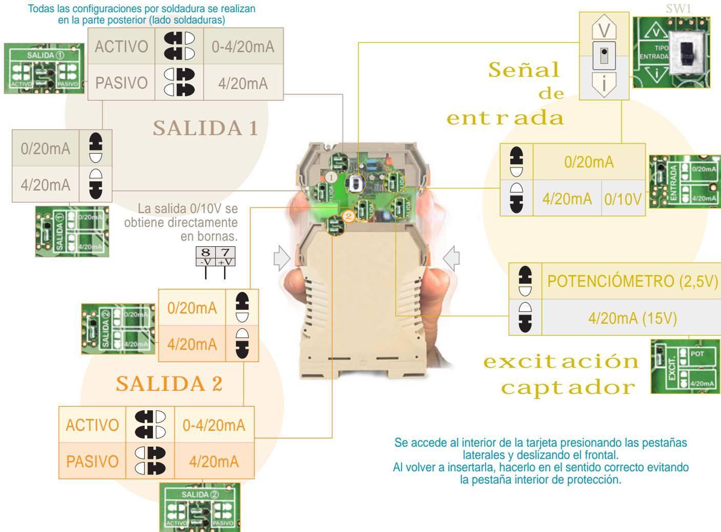
Se accede al interior de la tarjeta presionando las pestañas laterales y deslizando el frontal. Al volver a insertarla, hacerlo en el sentido correcto evitando la pestaña interior de protección.
